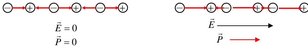
図 3-4 : イオンの振動による分極。
